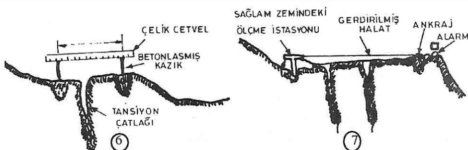
Şekil 6 ve 7. Çatlak ölçme yöntemleri.
