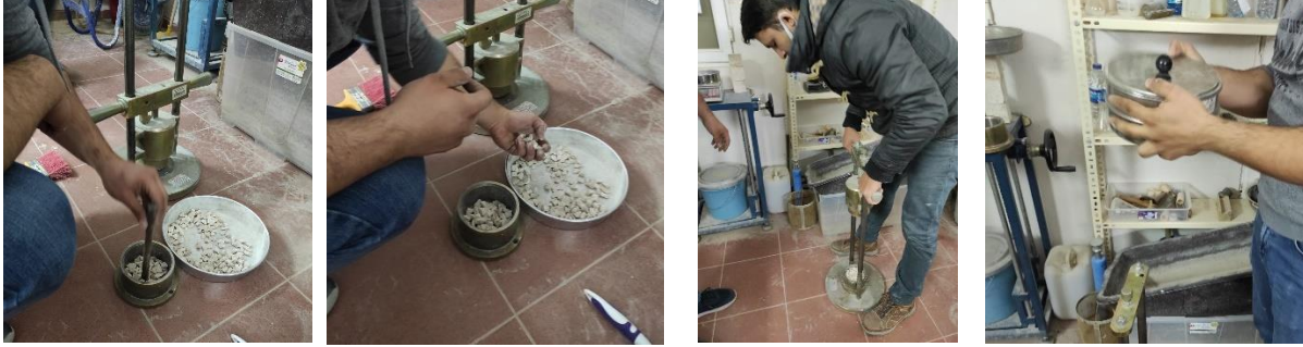
Şekil 4. Agregalar üzerinde gerçekleştirilen darbe dayanım deneyinden görüntüler.
